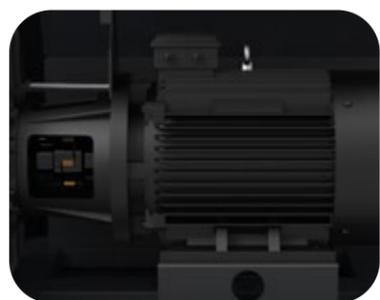
Синхронные электродвигатели с постоянными магнитами гарантируют максимальный КПД по всему диапазону регулирования производительности компрессора (от 40 до 100%), передача крутящего момента от двигателя осуществляется через упругую муфту.
