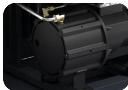
Синхронные электродвигатели с постоянными магнитами гарантируют максимальный КПД по всему диапазону регулирования производительности компрессора (от 40 до 100%). Масляное охлаждение обеспечивает эффективный отвод теплоты от двигателя, а подшипники не требуют дополнительного обслуживания.
