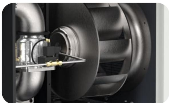
Охлаждение обеспечивается центробежным вентилятором с преобразователем частоты, что позволило дополнительно снизить уровень шума и повысить энергоэффективность компрессорной установки.
