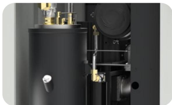
Продуманная система циркуляции масла гарантирует стабильную непрерывную работу компрессора, маслосепаратор обеспечивает фильтрацию сжатого воздуха от частиц масла, концентрация на выходе составляет 2 – 3 мг/м<sup>3</sup>.
