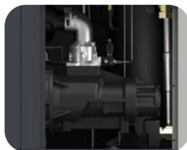
Интегрированный блок сжатия с маслоохлаждаемым синхронным двигателем на постоянных магнитах (до 75 кВт включительно) обеспечивает высокий КПД и надёжность. В блоке установлены 6 надёжных подшипников SKF, гарантия на блок – 36 месяцев.
