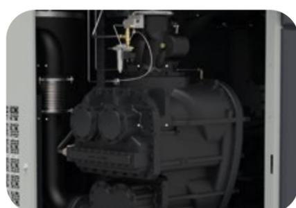
Интегрированный двухступенчатый блок сжатия с обеспечивает высокий КПД и надёжность, синхронизация валов обеспечивается шестерёнчатым редуктором. Параметры каждой ступени сжатия отслеживаются датчиками температуры и давления, каждая ступень оснащена 6 надёжными подшипниками SKF, гарантия на блок – 36 месяцев.
