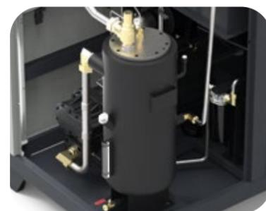
Продуманная система циркуляции масла гарантирует стабильную непрерывную работу компрессора, маслосепаратор обеспечивает фильтрацию сжатого воздуха от частиц масла, концентрация на выходе составляет 2 – 3 мг/м<sup>3</sup>.
